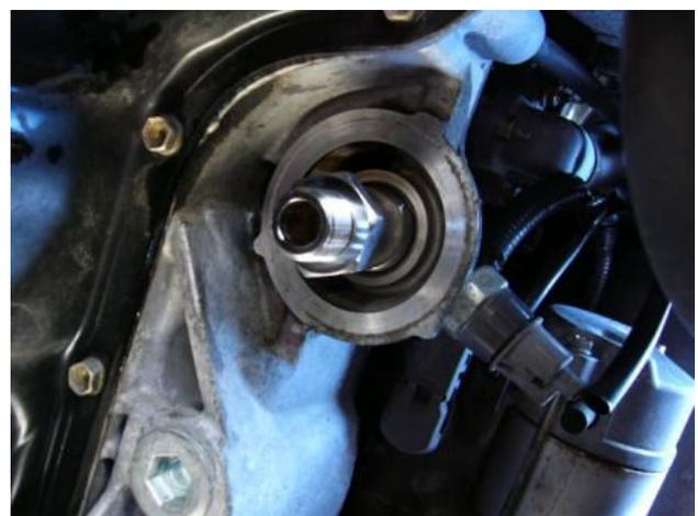
Questo blocco viene fornito con due guarnizioni di gomma, una grossa e una un po' più piccola, noi useremo la più piccola, bagnatela con un po' di olio pulito, posizionala nel blocco e posizionate il blocco con la parte della guarnizione verso il motore e fissatelo avvitando l'attacco giusto che avete individuato prima. Stringete bene questo attacco ma non esagerate, un domani potreste aver bisogno di toglierlo!!!
