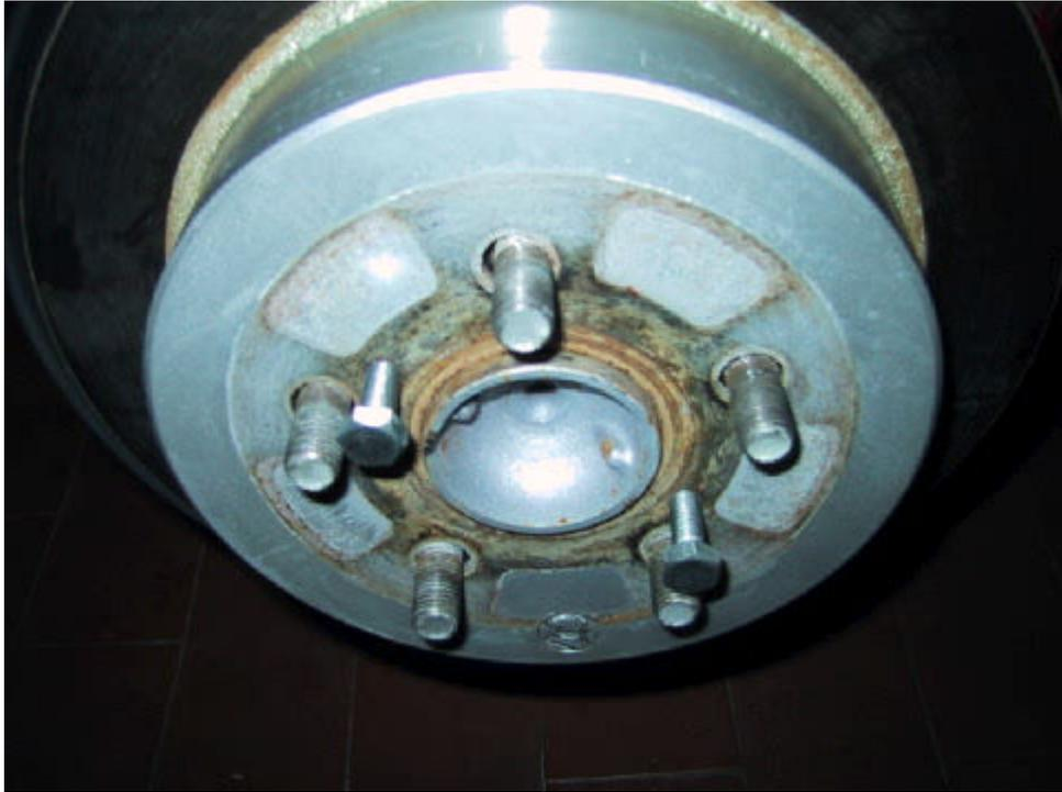
Nella foto successiva si vedono le ganasce freno a mano (che mordono all'interno campana disco) e come rimane il mozzo, una volta sfilato il disco stesso. Avete quindi anche l'opportunità per controllare bene lo stato di usura delle ganasce freno a mano. Notate inoltre che la pinza freno non deve rimanere penzoloni attaccata solo per il suo tubo in gomma.
