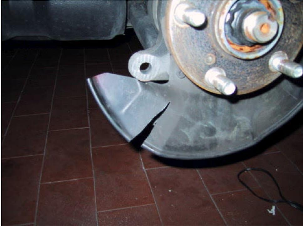
Ora, prima di inserire il nuovo disco anteriore (che nel mio caso trattasi di un Rotora "baffato e forato di dimensioni maggiori dell'originale) pulite accuratamente il mozzo da ruggine tramite una spazzola in ferro o semplice carta vetro.
