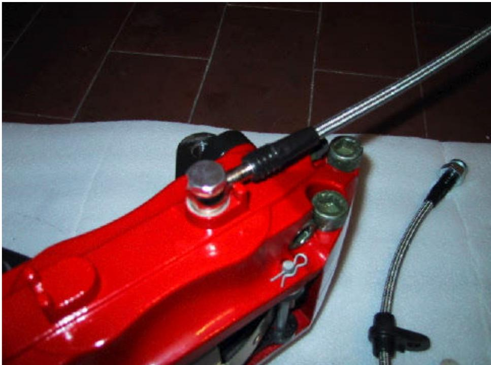
Chiaramente la nuova pinza monta già di serie pastiglie freni di tipo racing Rotor, ma se uno riutilizza la vecchia pinza è meglio che a dischi nuovi provveda ad utilizzare anche pastiglie nuove in modo che queste si adattino alla perfezione e non danneggino il nuovo disco con rigature o consumi non omogenei.
