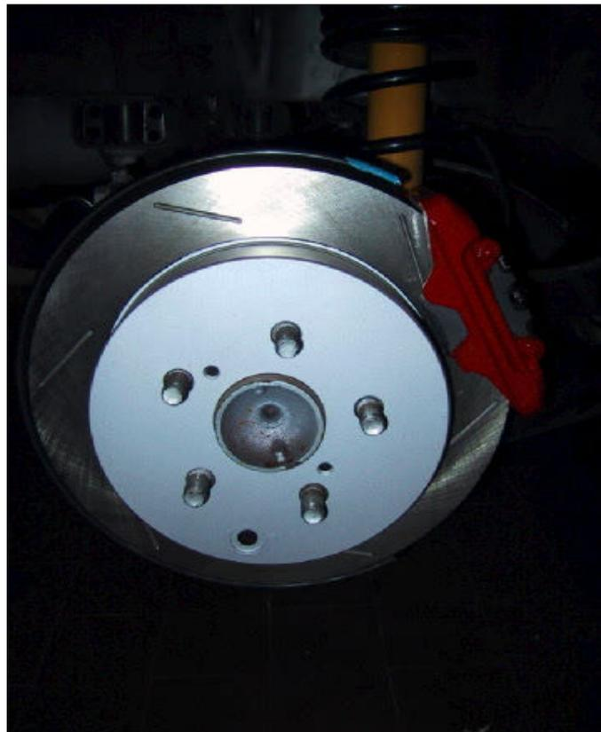
Non rimane che rimontare la ruota, procedere ad un leggero serraggio, togliere il crick e completare il serraggio dadi ruote. Procedere nella stessa maniera per l'altro disco posteriore.
